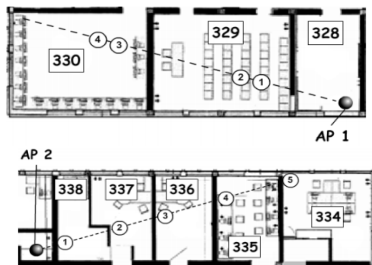
Figura 19. Posizionamento degli APs e distanze di misura per l'applicazione dell'Average Walls Model
